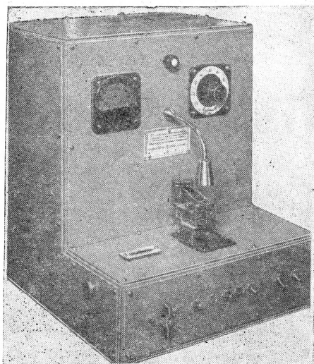
Рис. 13-3. Конденсаторная машина для сварки проволоки.
